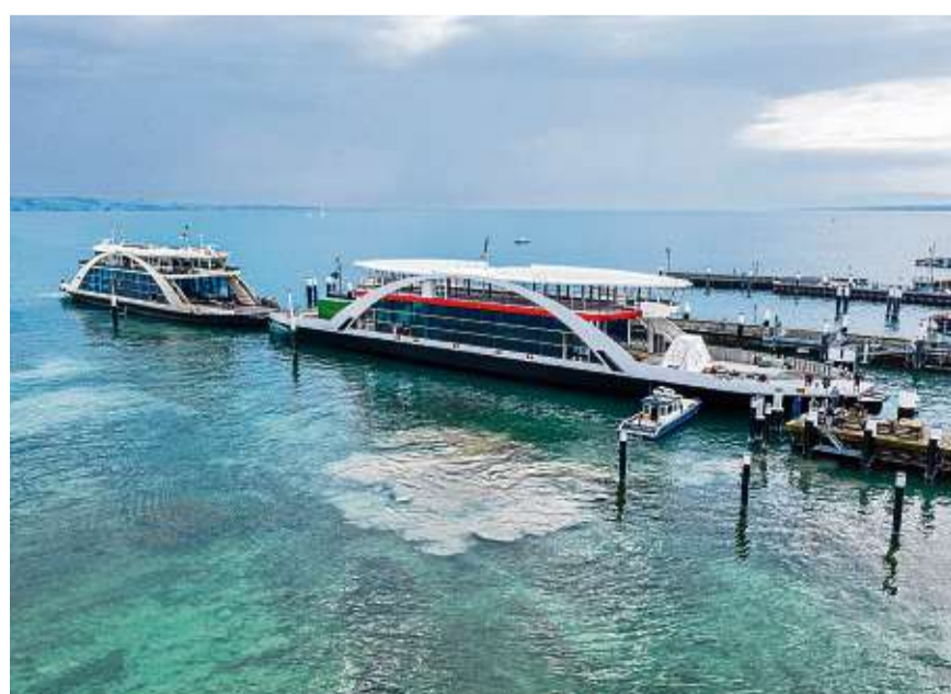
Die Fähre „Tabor“ schiebt den Rohbau der neuen Autofähre in Konstanz-Staad an ihren Platz, wo in den kommenden Monaten der Innenausbau erfolgt. BILD: LUKAS ONDREKA
